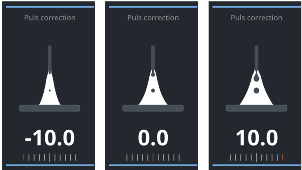
Näide: Keevitusparameeter impulsi korrektur -10 / 0 / +10
