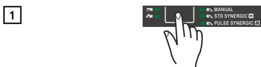
Нажмите кнопку Process (Процесс), чтобы выбрать процесс «Стандартная сварка MIG/MAG с режимом Synergic».
