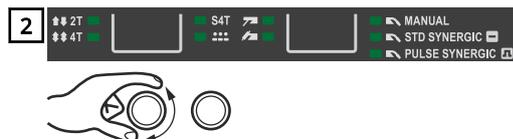
При помощи кнопок Mode (Режим работы) и Process (Процесс) или регулировочной ручки слева выберите нужный параметр.
