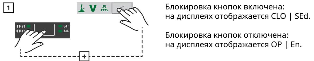
Блокировку кнопок можно включать и отключать при помощи ключа-переключателя.
