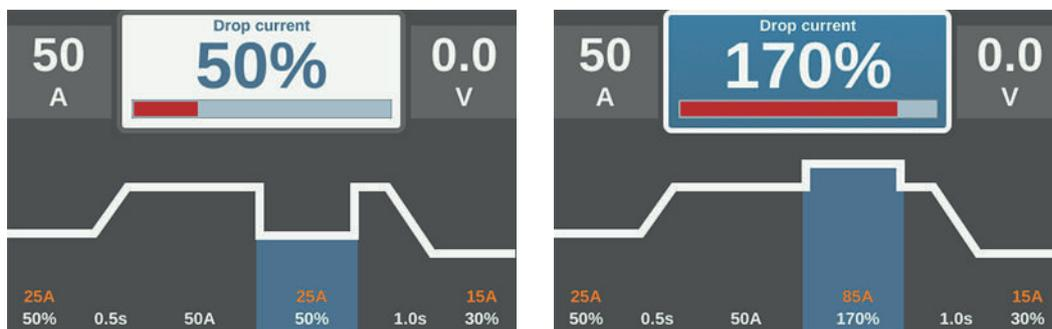
Сниженный ток  $I_2 <$  рабочего тока  $I_1$  | Сниженный ток  $I_2 >$  рабочего тока  $I_1$
