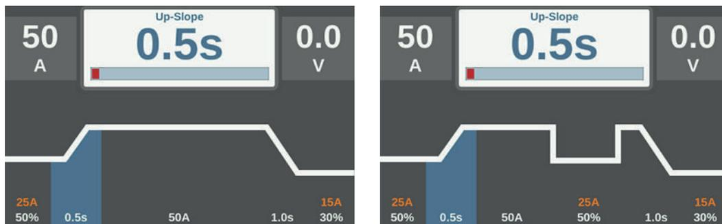
Нарастание: 2-тактный режим и точечная сварка | 4-тактный режим
